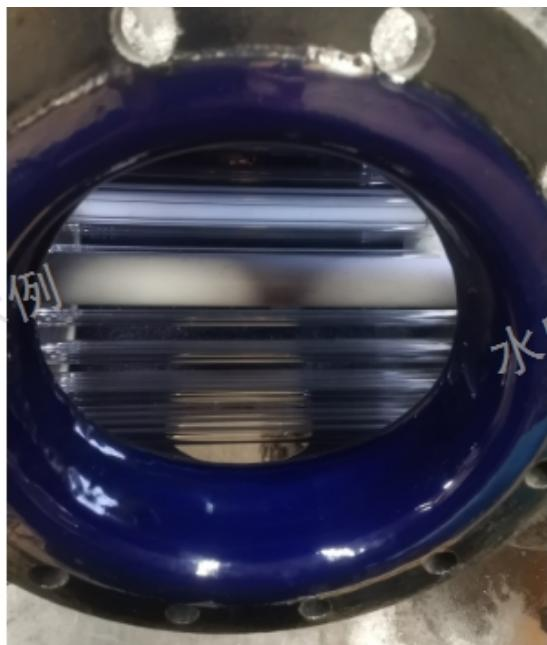
新型可拆式搪玻璃列管式换热器规格尺寸表换热器换热管换热面积( $m^2$ )内径(DN)外径(DN)总长度(h)数量规格长度总换热效率值480~550W/ $\square\text{m}\cdot\text{K}$ 工作压力0.1~0.6Mpa工作温度:-20~250℃优点：传统搪玻璃列管皆采用搪玻璃管板与换热管整体烧制工艺，由于管板自身应力原因这种工艺过不了关，一旦一点爆瓷整台报废。新型可拆式搪玻璃列管式换热器管板采用钢衬模压一体成型PFA管板，不存在爆瓷风险，内搪玻璃和管板采用填料螺纹密封，换热管强度高，做到单根可堵单根可拆卸，降低了用户使用成本，既可用于冷却降温，也可用于蒸汽和导热油的加热。换热器，就选无锡市伟业化工防腐设备厂，让您满意，欢迎您的来电哦！浙江列管式碳化硅换热器泄露
